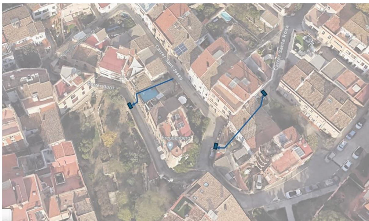
Fig. 15. Pas d'aigua pluvial per l'interior de finques privades.
